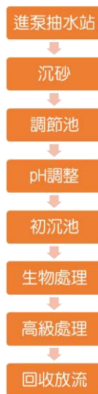
圖 4-11 污水處理流程示意圖
