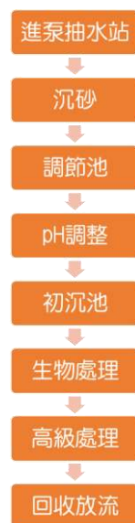
圖 4-11 污水處理流程示意圖
