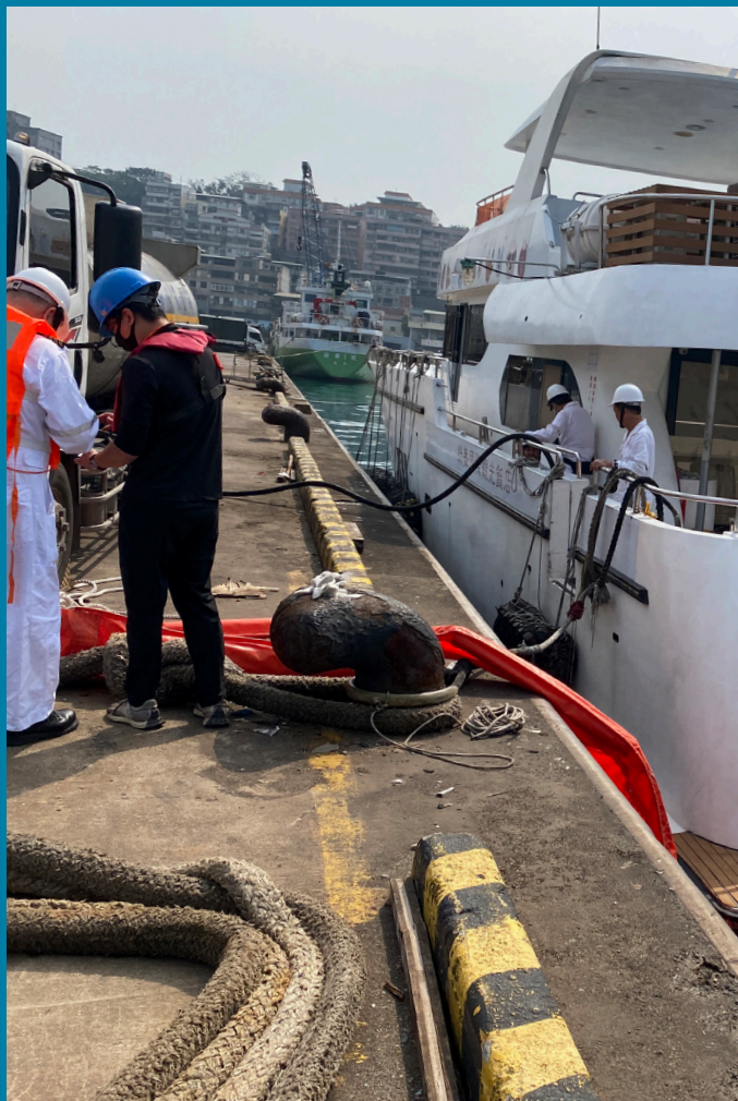
船舶加油作業情形
