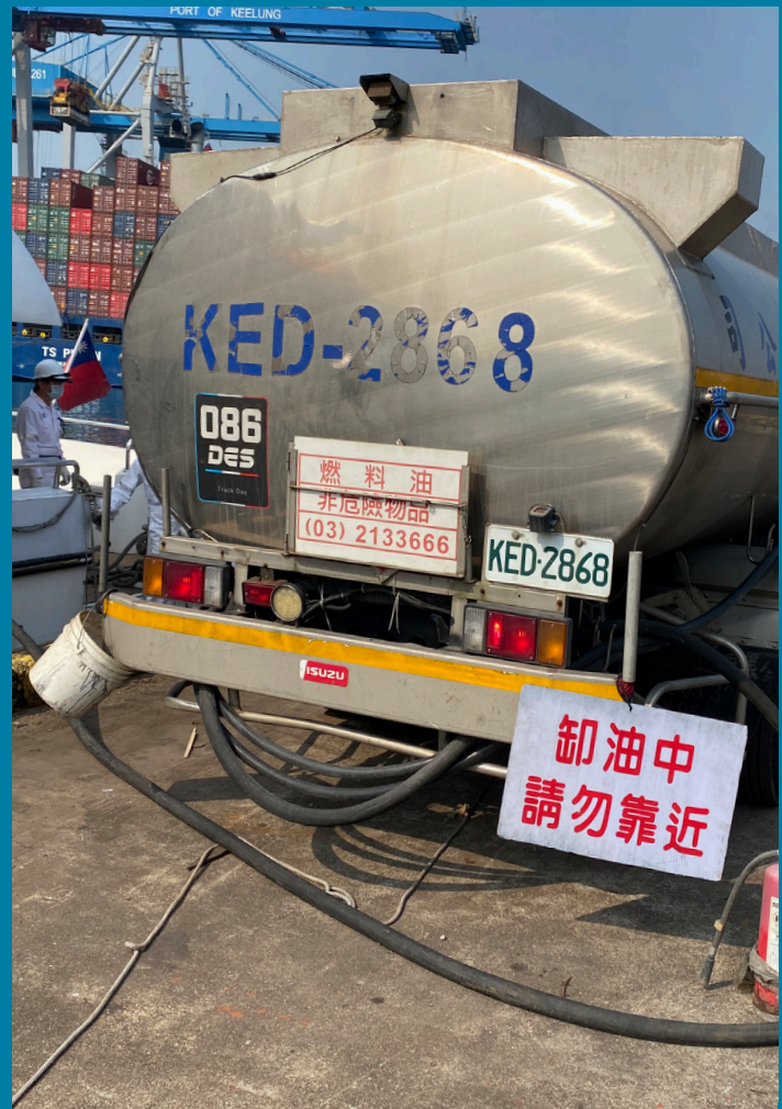
油罐車加注船舶（超級柴油 2,500 公升）作業
