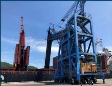
自動卸煤機與水霧機：增加運作效率，減少揚塵
