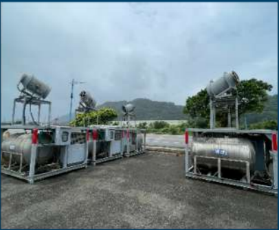
自動卸煤機與水霧機：增加運作效率，減少揚塵
