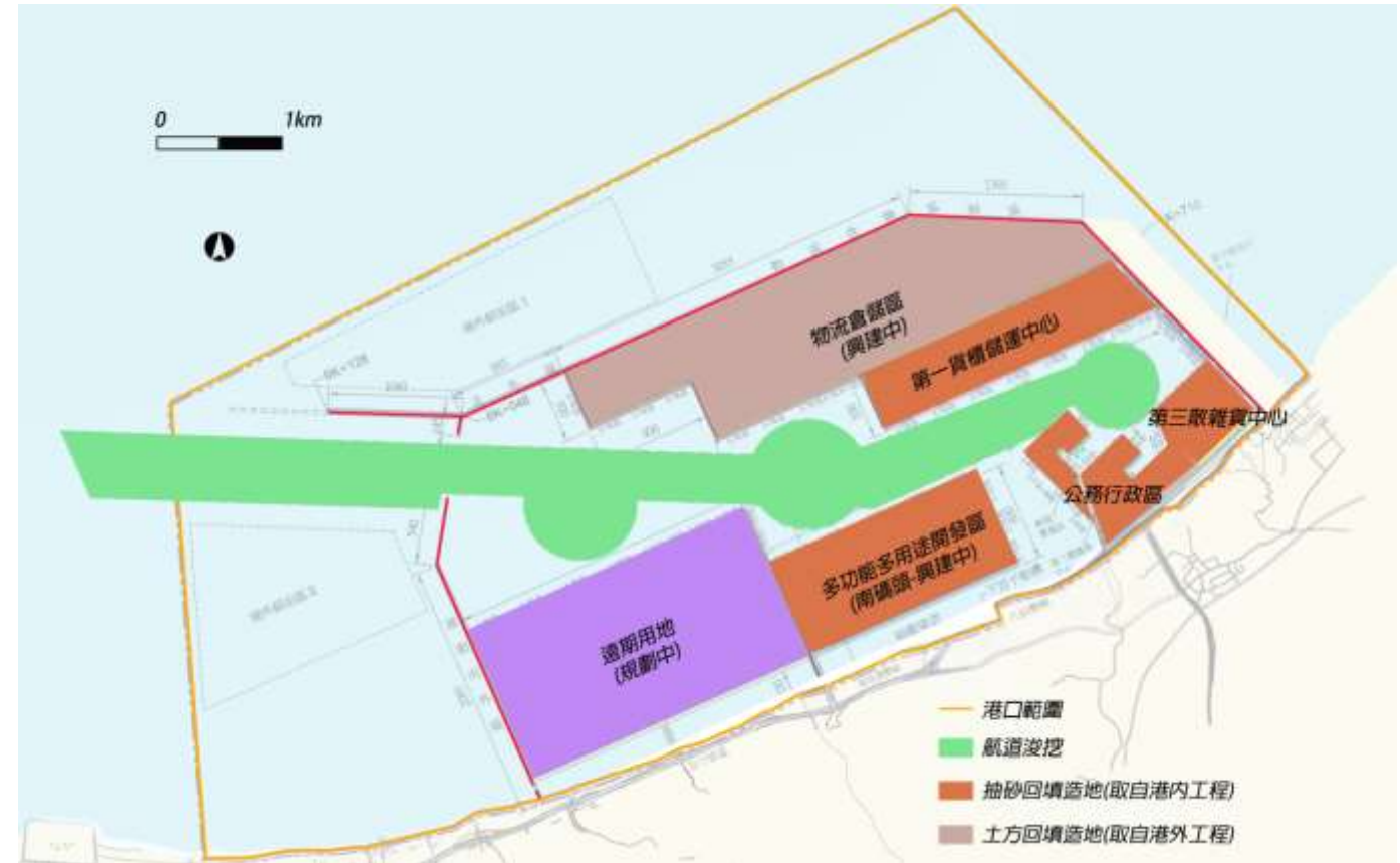
>>臺北港航道浚挖與回填造地示意圖
