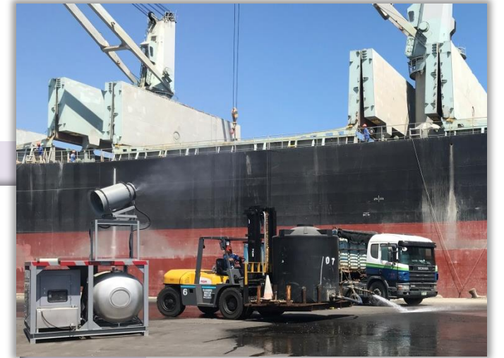
每隻抓斗需配1台水霧機，以降低粉塵逸散；卸料抓斗必須觸底卡車底部後，始得以開斗卸料，以減少粉塵揚起。
