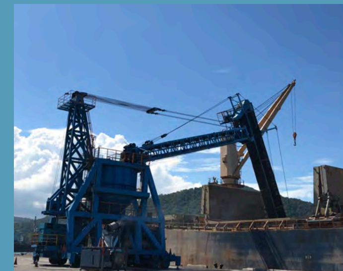
蘇澳港主要貨物包含煤炭，使用自動卸煤機能夠增加運作效率也減少污染排放。
