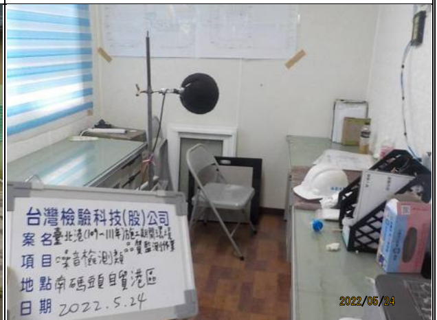
監測項目：低頻營建噪音 監測日期：111.5.24 監測地點：南碼頭自貿港區
