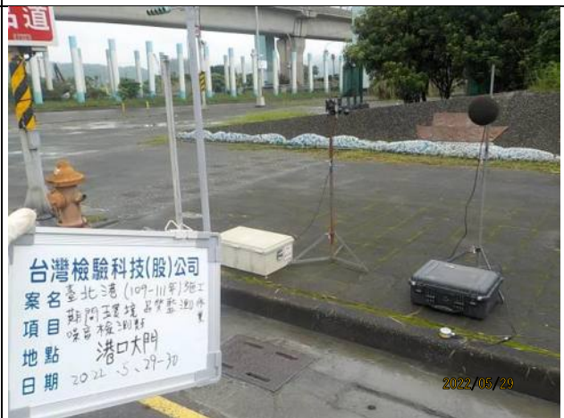
台灣檢驗科技(股)公司 案名 臺北港(109-111年)施工 期間至環境品質監測作業 項目 噪音檢測類 地點 港口大門 日期 2022.5.29-30 2022/05/29 監測項目：噪音振動監測(假日&非假日) 監測日期：111.5.29~30 監測地點：港口大門
