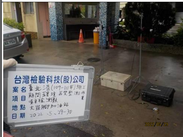
台灣檢驗科技(股)公司 案名 臺北港(109-111年)施工 期間至環境品質監測作業 項目 噪音檢測類 地點 大崁腳加油站 日期 2022.5.29-30 2022/05/29 監測項目：噪音振動監測(假日&非假日) 監測日期：111.5.29~30 監測地點：大崁腳加油站
