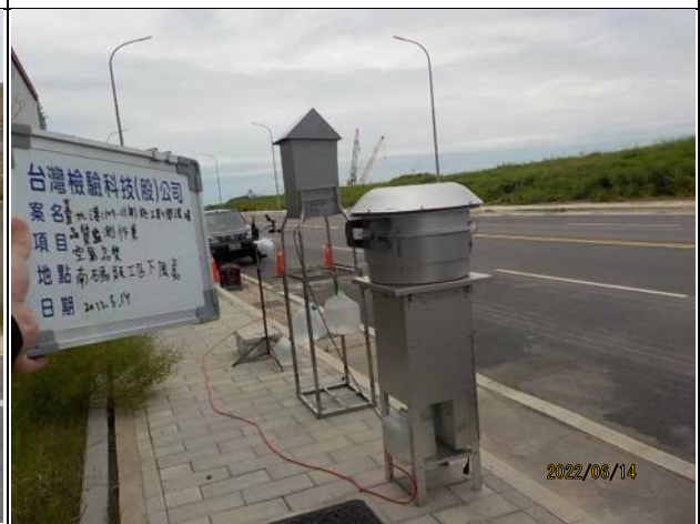
監測項目：周界空氣 監測日期：111.6.14 監測地點：南碼頭工區下風處
