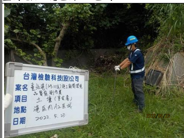
監測項目：土壤(重金屬) 監測日期：111.5.23 監測地點：港區內 A2 區域
