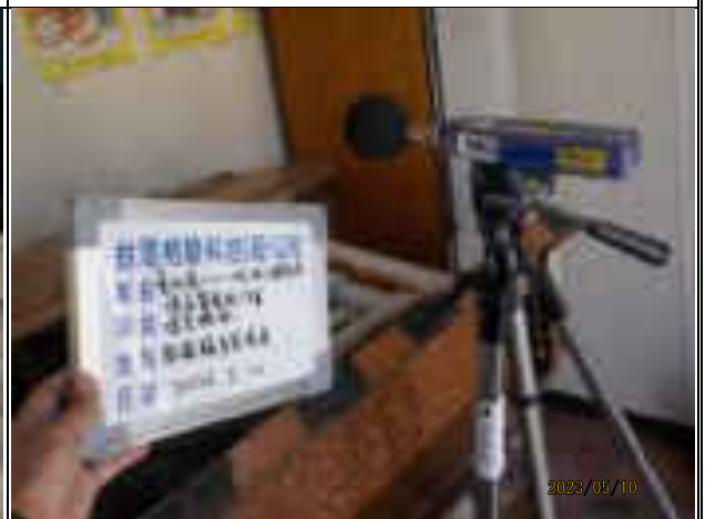
監測項目：低頻營建噪音 監測日期：112.5.10 監測地點：南碼頭自貿港區
