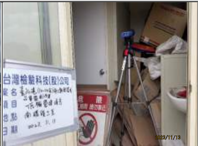
監測項目：低頻營建噪音 監測日期：112.11.13 監測地點：南碼頭工區
