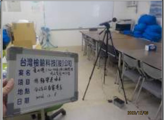
監測項目：低頻營建噪音 監測日期：112.12.8 監測地點：南碼頭自貿港區
