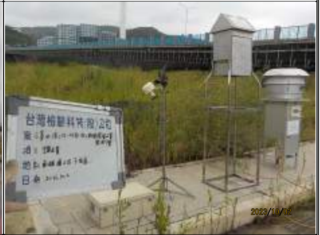
監測項目：周界空氣 監測日期：112.10.2 監測地點：南碼頭工區下風處
