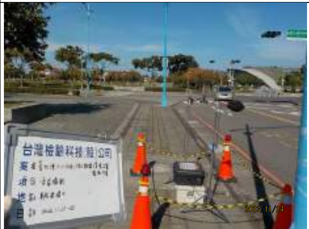
監測項目：噪音振動監測(假日&非假日) 監測日期：11.24~25 監測地點：東防波堤口
