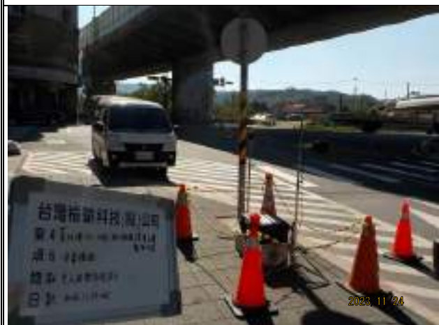
監測項目：噪音振動監測(假日&非假日) 監測日期：11.24~25 監測地點：中山路與商港路口
