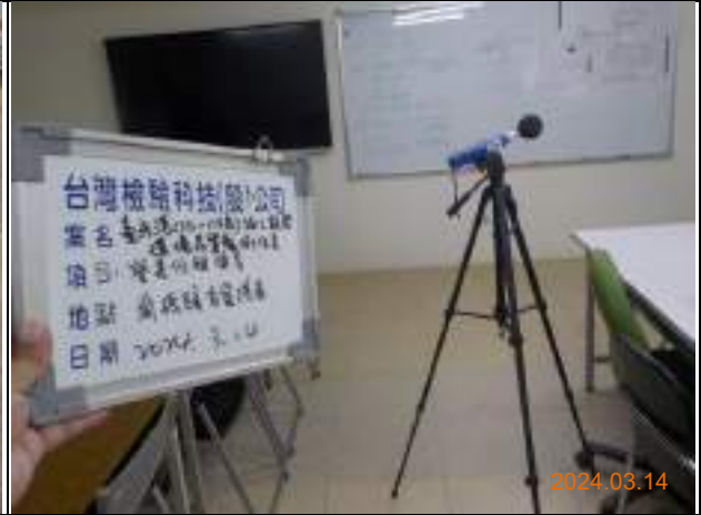
監測項目：低頻營建噪音 監測日期：113.3.14 監測地點：南碼頭自貿港區
