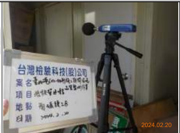
監測項目：低頻營建噪音 監測日期：113.2.20 監測地點：南碼頭工區
