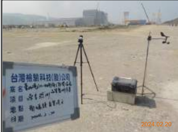
監測項目：營建噪音 監測日期：113.2.20 監測地點：南碼頭自貿港區
