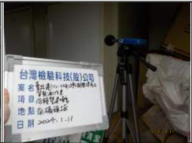
監測項目：低頻營建噪音 監測日期：113.1.11 監測地點：南碼頭工區
