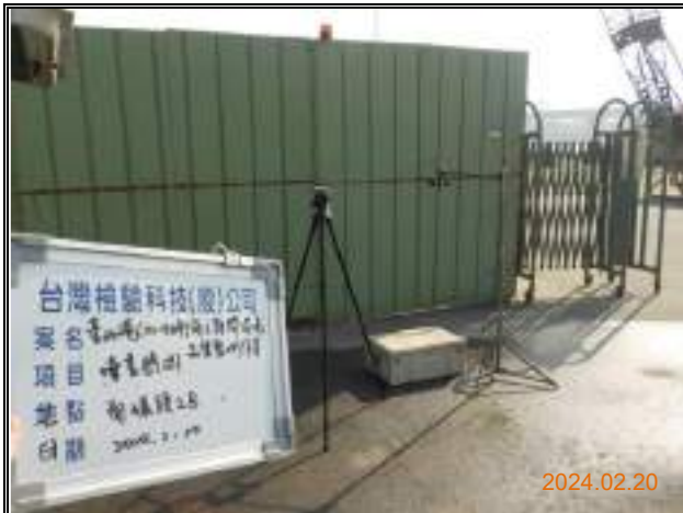
監測項目：營建噪音 監測日期：113.2.20 監測地點：南碼頭工區
