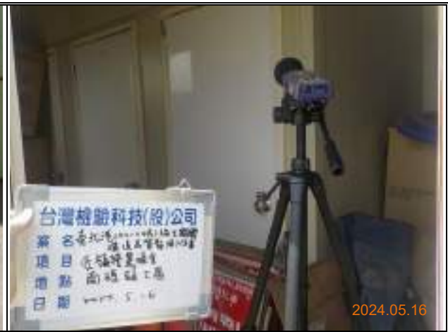
監測項目：低頻營建噪音 監測日期：113.5.16 監測地點：南碼頭工區
