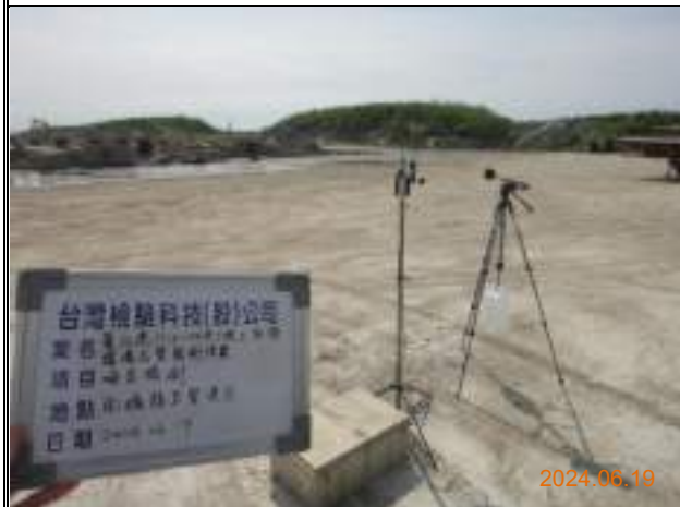
監測項目：營建噪音 監測日期：113.6.19 監測地點：南碼頭自貿港區
