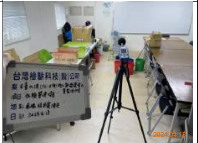
監測項目：低頻營建噪音 監測日期：113.4.18 監測地點：南碼頭自貿港區
